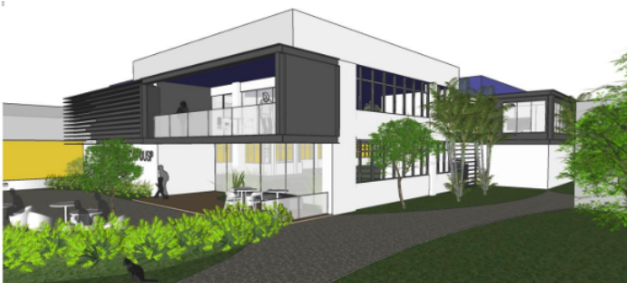
Efeito volumétrico de caixa projetada em balanço
